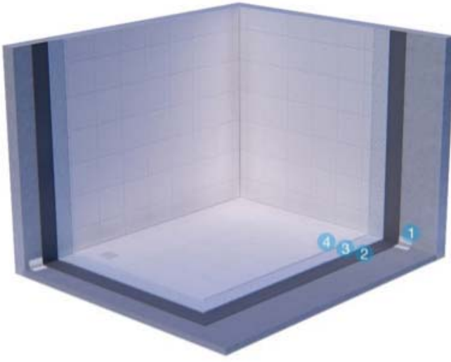
Şekil 3: Islak hacimlerde su yalıtımı
